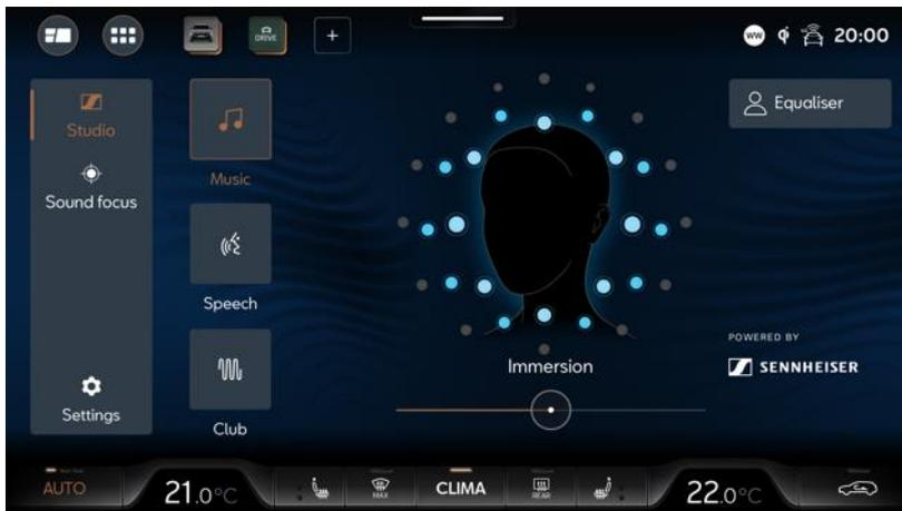
Die AMBEO Concerto-Software von Sennheiser filtert die grundlegenden Komponenten eines jeden Musikstücks, einschließlich verschiedener Instrumente und Rauminformationen, um sie anschließend im gesamten Fahrzeug neu zu verteilen.
